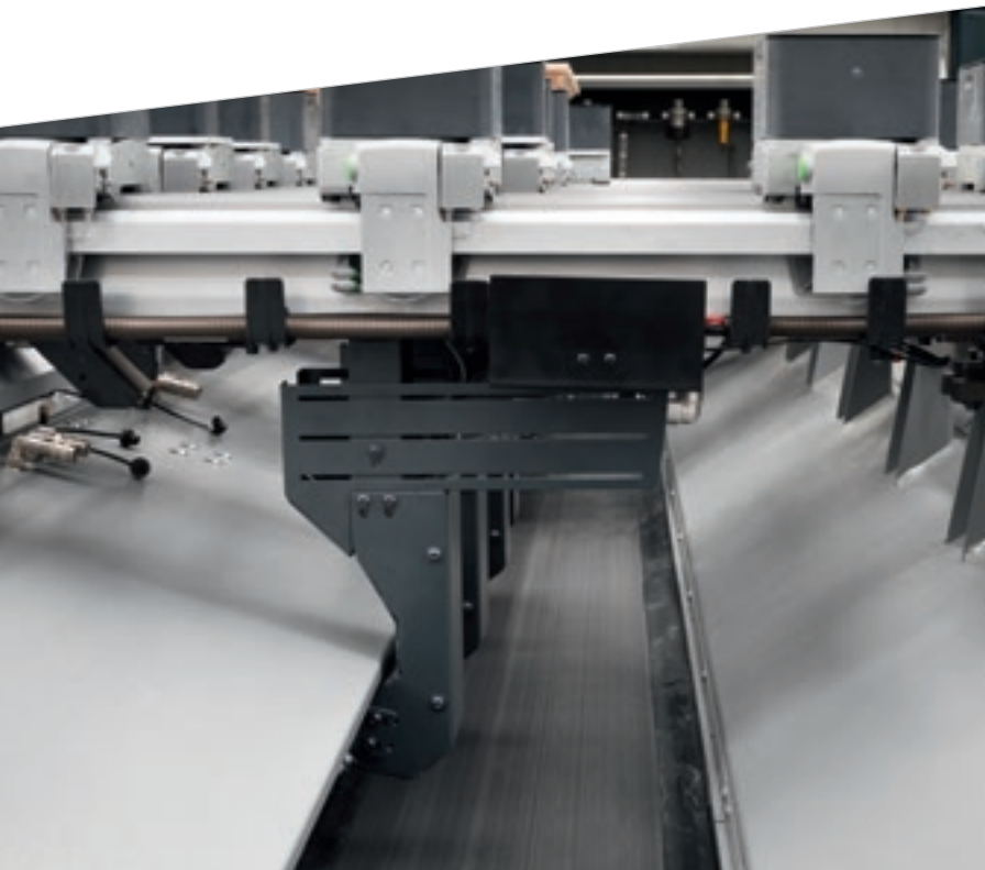
Tappeto motorizzato con carrello con raccolta per la rimozione di trucioli e sfridi.
