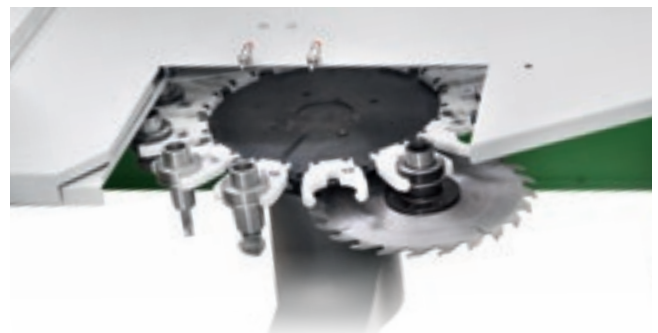
Magazzino utensili a revolver 13/16 posizioni.
